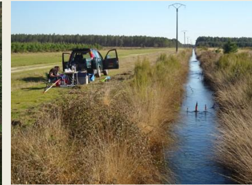
Figure 1 : Schéma des interactions eau-air-roche du cycle du carbone dans les nappes karstiques, les nappes sableuses et les rivières Image 2 : Source karstique de la Pescalerie qui se jette dans le Célé (Causses du Quercy, Lot) Image 3 : Suivi des pressions partielles en O 2 et CO 2 dans un fossé affluent de la Leyre à Bilos (33) au cours d'un cycle de 24h
